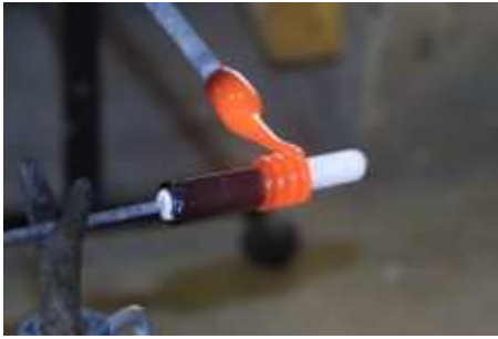
Figuur 16. Het draaien van glas om een kern ( http://www.romanglassmakers.co.uk ).
