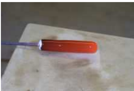
Figuur 17. Het gladmaken van het oppervlak van het glas ( http://www.romanglassmakers.co.uk ).
