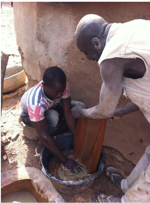
Foto 7: Goudstof gaat van handdoek in simple tire .
