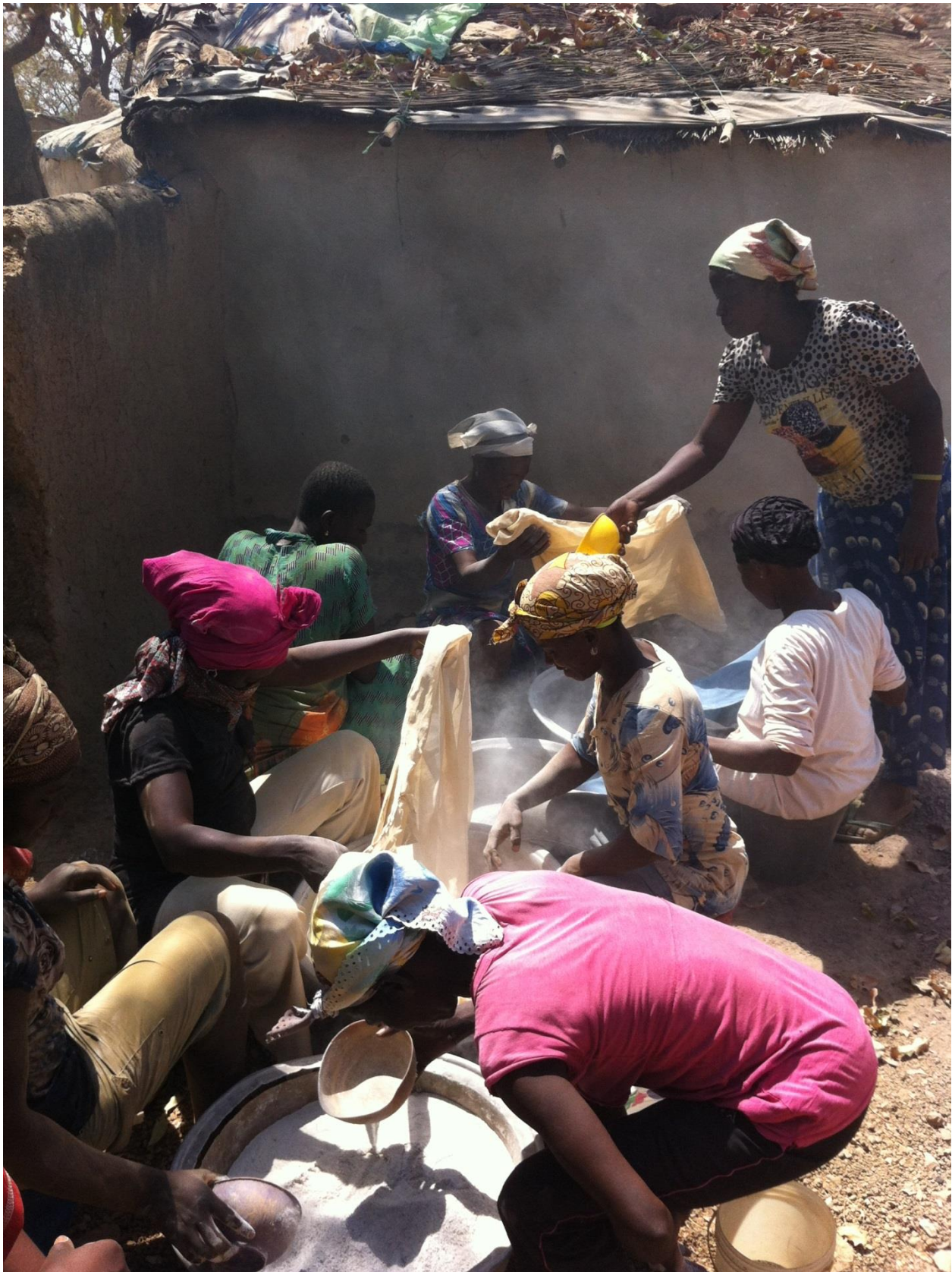
Foto 5: Vrouwen zijn het steengruis en steenstof aan het schudden.
