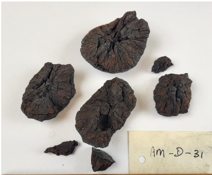
Figuur 2.14: Deze kanonskogel lijkt de enige geconserveerde kogel van Aanloop Molengat te zijn met mechanisch verval. Hij is uiteengevallen, veel ijzerverlies is waargenomen (zie tabel 2.1), en corrosieproducten zijn zichtbaar aan de binnenzijde. (Batavialand, Maritiem Archeologisch Depot, AM-D-31, M. Brouwer, 2022)
