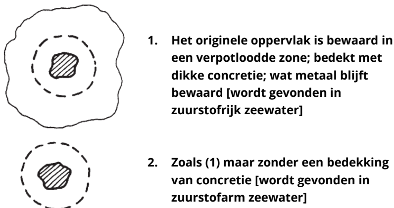
Figuur 2.10: Dwarsdoorsnede van een gietijzeren kanonskogel. Algemene condities van ijzerwerk gevonden tijdens opgraving. (naar Cronyn & Robinson 1990, p. 182)
