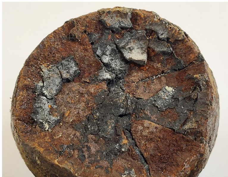
Figuur 2.9: Het afbladderen van zwarte vlokken aan de gebroken binnenzijde van de kanonskogel. (Batavialand, Maritiem Archeologisch Depot, ZWa1959-X12, M. Brouwer, 2022)
