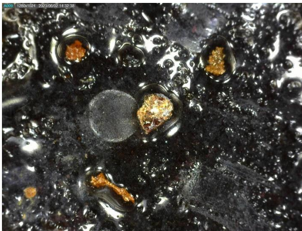
Figuur 2.11: Ijzer corrosie puntjes zichtbaar onder het oppervlak. Zij lijken de kunststof laag naar buiten te duwen. 120x uitvergroot met Dino-Lite Pro2 AM4000 series. (Batavialand, Maritiem Archeologisch Depot, SO1-37051, M. Brouwer, 2023)
