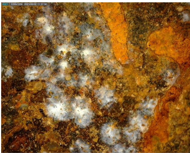
Figuur 2.4 (links onder): Onbekende witte spikkels op het oppervlak. Ook uitvergroot zijn geen kristallen zichtbaar. 200x uitvergroot met Dino-Lite Pro2 AM4000 series. (Batavialand, Maritiem Archeologisch Depot, AM-1992-20, M. Brouwer, 2023)
