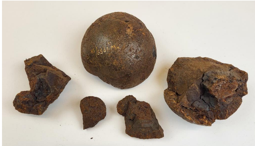
Figuur 2.13: Deze kogel lijkt op een wijze te zijn geconserveerd, maar is desondanks in stukken uiteen gevallen. Aan de binnenzijde zijn corrosieproducten zichtbaar. (Batavialand, Maritiem Archeologisch Depot, ZWa-1959-IX15, M. Brouwer, 2022)
