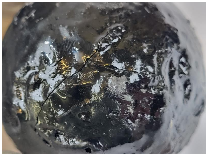
Figuur 2.15: Een kanonskogel van ScheurrakSO1 met een scheur. Wanneer vergroot onder een handmicroscopie kan een conserveringslaag worden waargenomen binnenin de scheur. (Batavialand, Maritiem Archeologisch Depot, SO1-32536, M. Brouwer, 2022)
