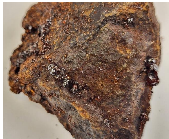
Figuur 2.12: Weeping iron, zichtbaar als donkerrood-bruine blaasjes. Een specifieke soort corrosie zichtbaar aan de binnenzijde van deze gebroken kogel. (Batavialand, Maritiem Archeologisch Depot, ZWa1959-X13, M. Brouwer, 2022)
